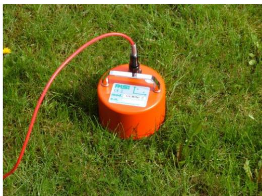
**Foto 6** – Acquisizione sismica a stazione singola (Tromino®).
